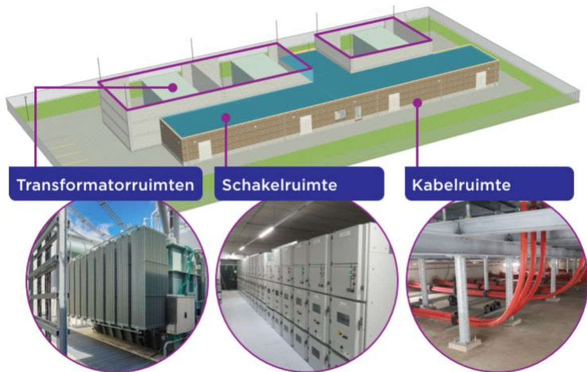
Figuur 4: Schematische weergave modulair 150/20 kV-onderstation.
